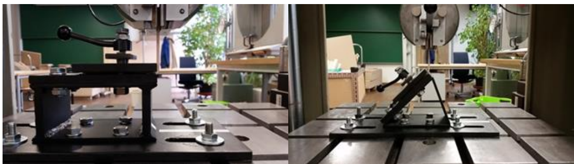
Abbildung 3-5: Einspannvorrichtung zur Zugspannungsprüfung im 90^\circ Winkel (links) und 45^\circ Winkel (rechts) montiert auf einer Universalprüfmaschine. (Foto: Peter Werndl)
