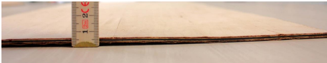
Abbildung 4-31: Foto der Faltfurnierplatte mit den auffälligsten Veränderungen nach der Lagerung im Wechselklima.
