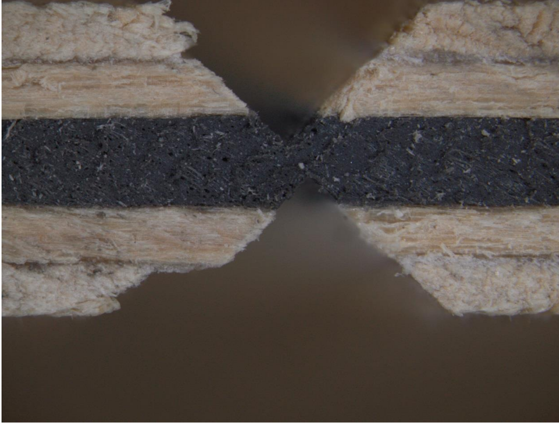
Abbildung 2-5: Seitliche Aufsicht auf eine beidseitig eingefräste Faltfurnierplatte. Hier mit durch den Fräskopf beschädigter Mittelschicht (Foto: P. Werndl).
