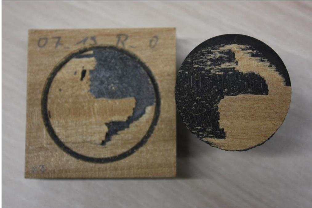
Abbildung 4-6: Beispiel für eine fehlerhafte Abhebefestigkeitsprüfung. Das Furnier wurde durch den Prüfpilz nicht flächig abgelöst und das Versuchsergebnis somit verworfen.
