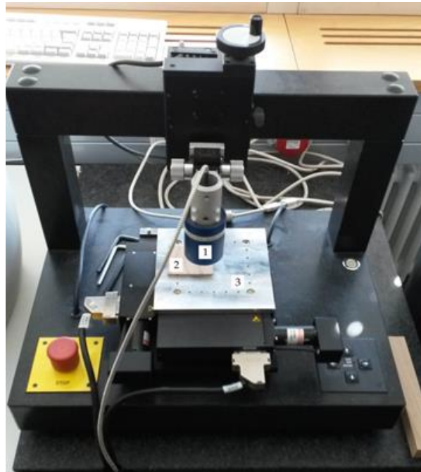
Abbildung 3-1: Micro Prof mit Erlenfurnierprobe bestückt. 1- Optischer Messkopf, 2- Probekörper aus Erlenfurnier und 3- Beweglicher Prüftisch.
