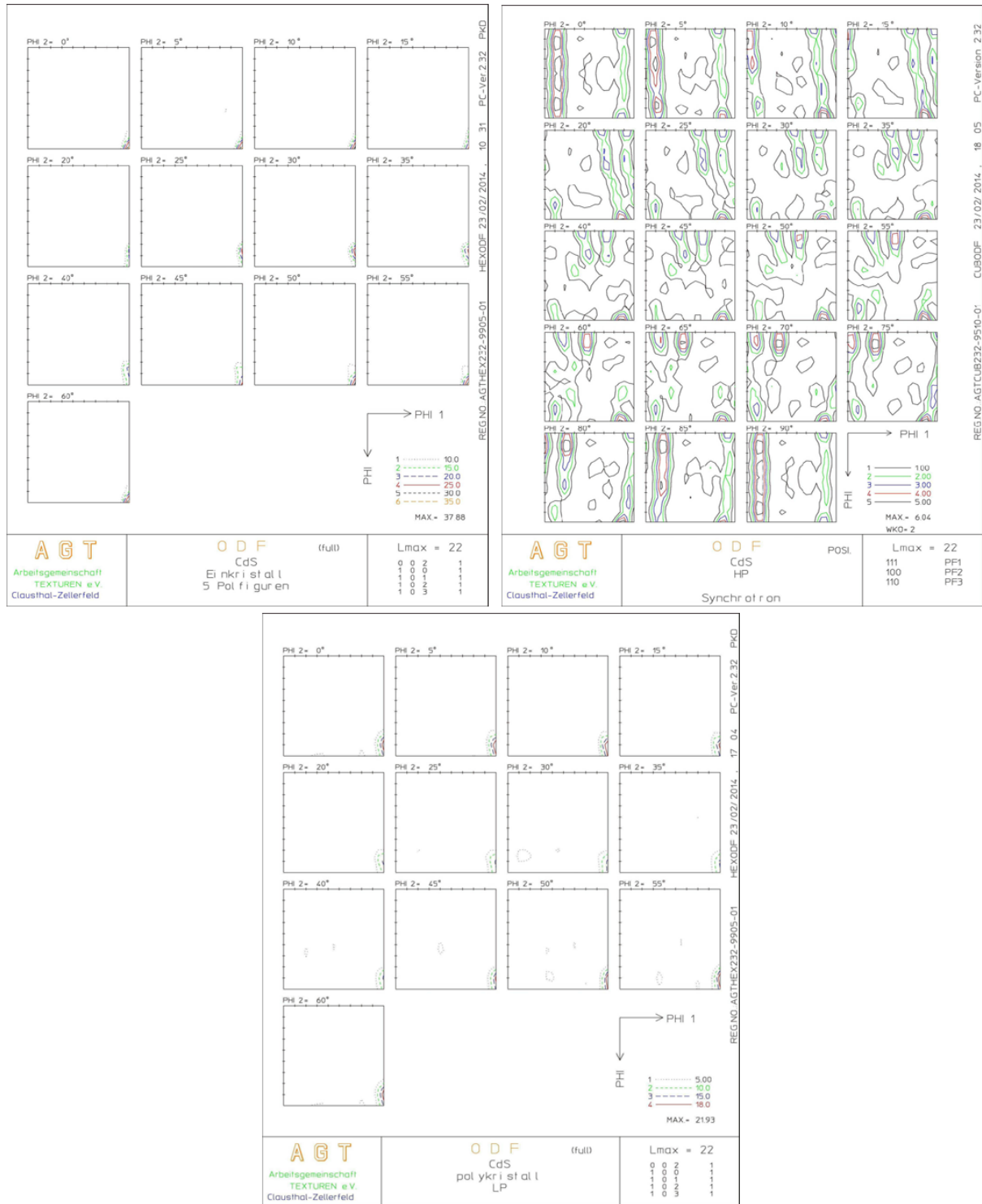
Abbildung 10.8: Vollständige Eulerraumschnitte des CdS -Experiments okt13. Für den Einkristall und die entlastete polykristalline Niederdruckphase im Wurtzit-Typ worden die Schnitte im Bereich 0^\circ \leq \varphi_2 \leq 60^\circ erstellt, für die Hochdruckphase im NaCl -Typ im Bereich 0^\circ \leq \varphi_2 \leq 90^\circ . Die Schrittweite beträgt \Delta\varphi_2=5^\circ .
