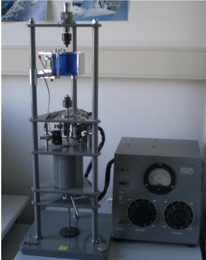
Abb. 15: Kapillarschlingenziehgerät (Puller) zum Ziehen der Mikrokapillaren und der Injektionskapillaren. In der Mitte des Gerätes sitzt eine Heizspirale, welche die Kapillaren erhitzt. Durch Anlegen eines Magnetfelds wird die erhitzte Kapillare auseinander gezogen, sodass zwei an der Spitze konisch zusammenlaufende Glaskapillaren entstehen.
