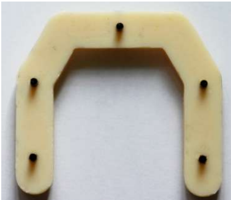
Abbildung 14: Beispiel eines Prüfkörpers mit geschwärtzter Pin-Oberfläche
