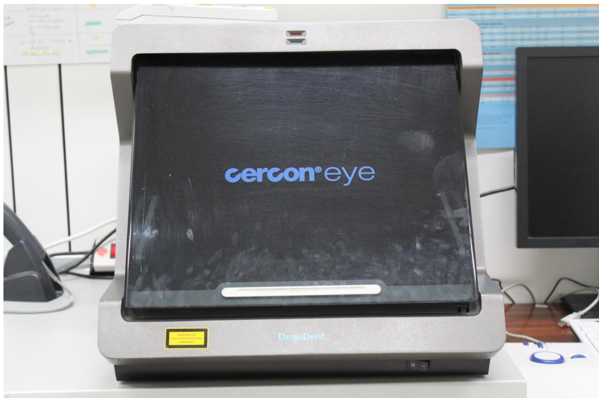
Abb. 8: Cercon® eye Scanner der Firma DeguDent (Hanau)
