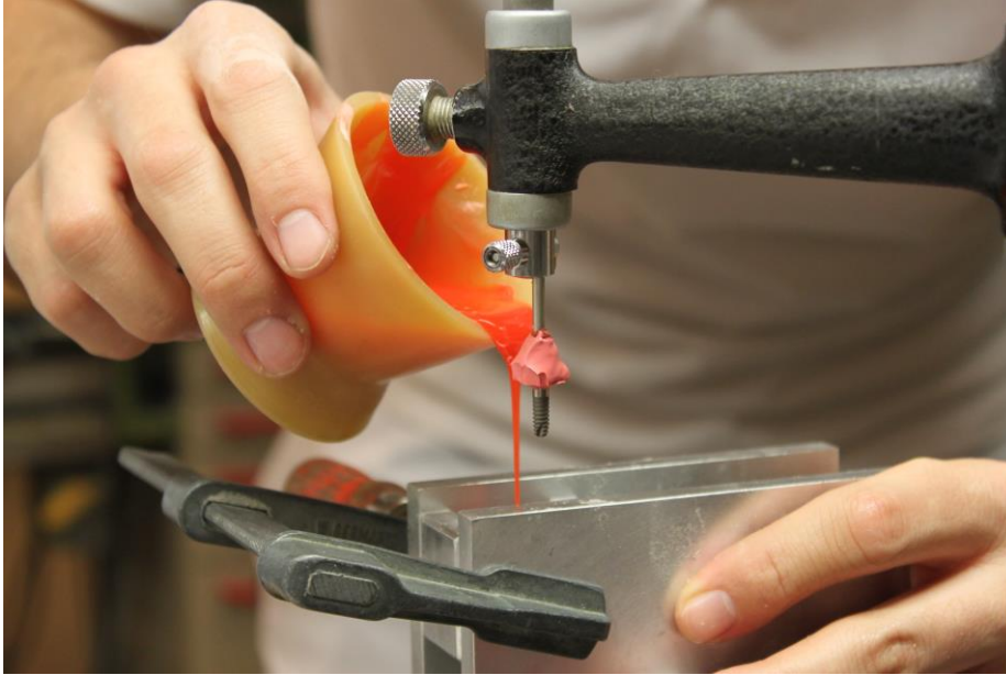
Abb. 7 a): Ausgießen der Hohlform mit Palavit G
