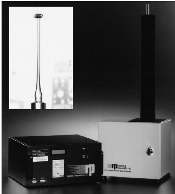
Abbildung 15: TEOM 1400a und Hohnadel mit Filter (Patashnick und Rupprecht, 1991).
