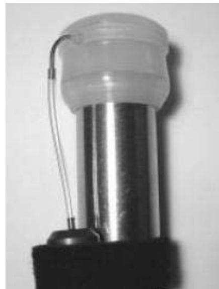
Abbildung 5: Die Messstellen im Melkzeug (verändert nach Werkbild GEA Farm Technologies, D 59199 Bönen)
