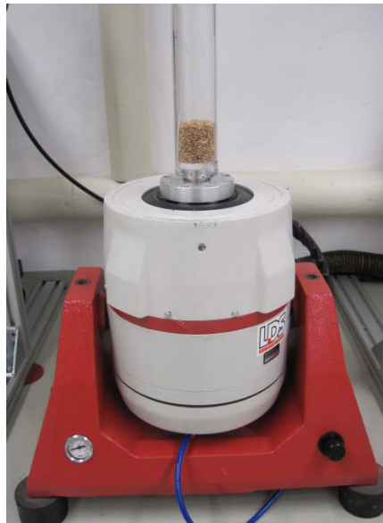
Abb. 6: LDS-Shaker mit aufgeschraubtem Versuchsbehälter
