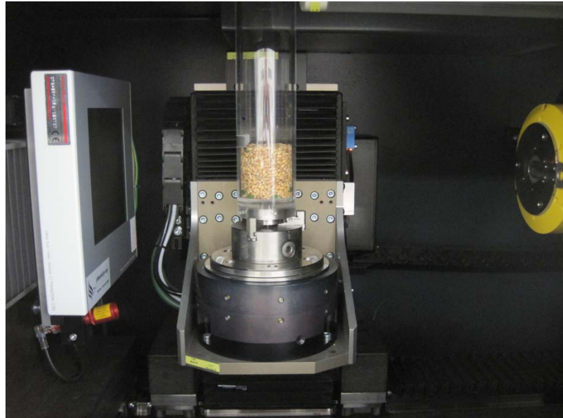
Abb. 7: Versuchsbehälter zwischen Detektor (links) und Röntgenröhre (rechts) des Nanotoms
