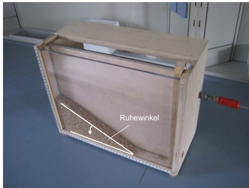
Abb. 5: Hele-Shaw-Zelle Bauart Agrartechnik gefüllt mit 300 g unbehandeltem Weizen
