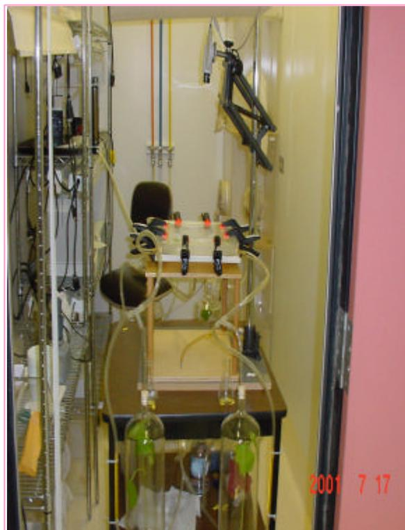
**Fig. (1) Olfactometer System**
