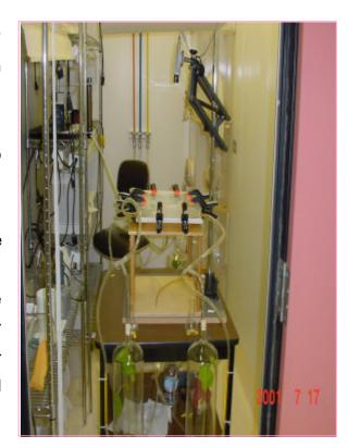
Fig. (1) Olfactometer System
