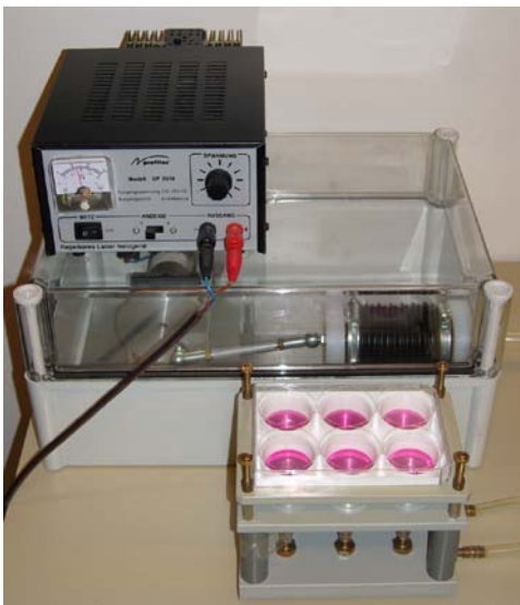
Abbildung 4: 6-Well-BioFlex-Zellkulturschale mit angeschlossener Vakuumpumpe. Im Vordergrund ist die eingespannte Bio-Flex-Schale zu sehen, wobei sich in den drei oberen Wells die ungedehnten Zellen (Kontrollen) befinden und in den unteren drei Wells die zu dehrenden Zellen. Im Hintergrund steht die Vakuumpumpe, die mit der Bio-Flex-Schale und einem regelbaren Netzgerät verbunden ist.
