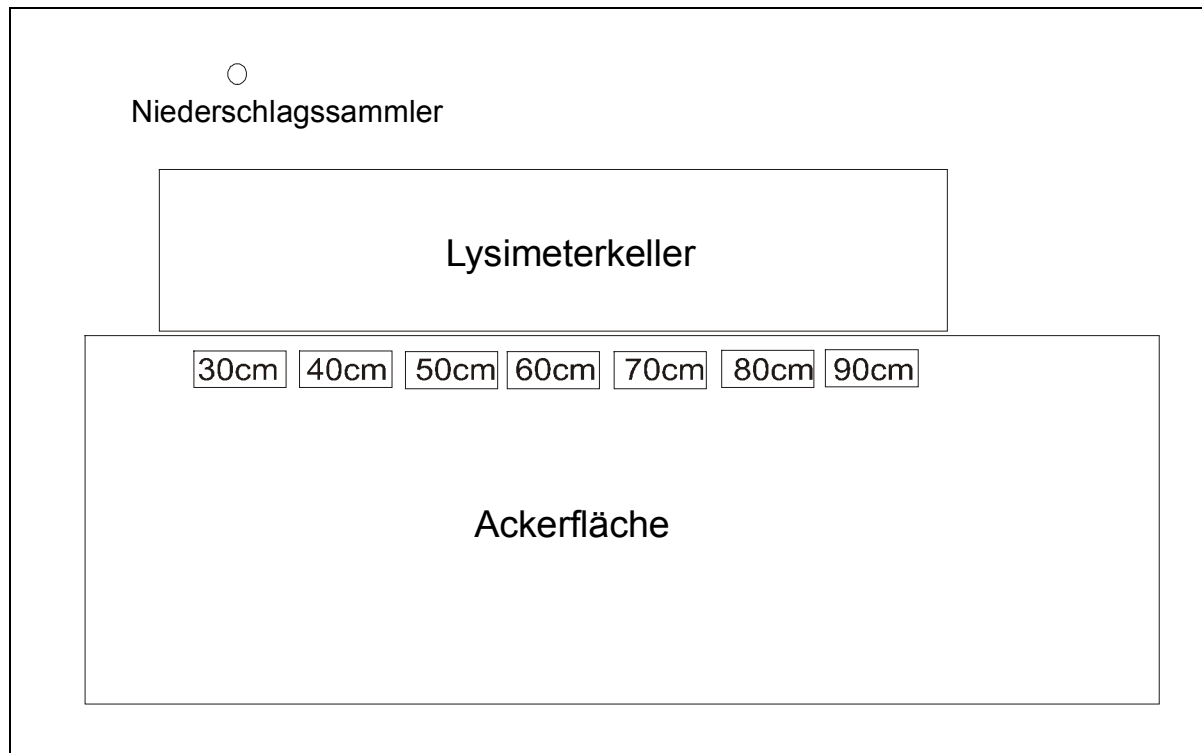
Abbildung 3: Anordnung der Plattenlysimeteranlage am Kleinen Knüll; Breite der Ackerfläche 10 m; Norden ist oben, weitere Erläuterung im Text
