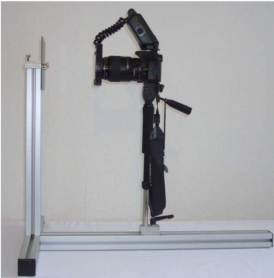
Abbildung 4.1: Haltevorrichtung für Kamera und Zahnprobe
