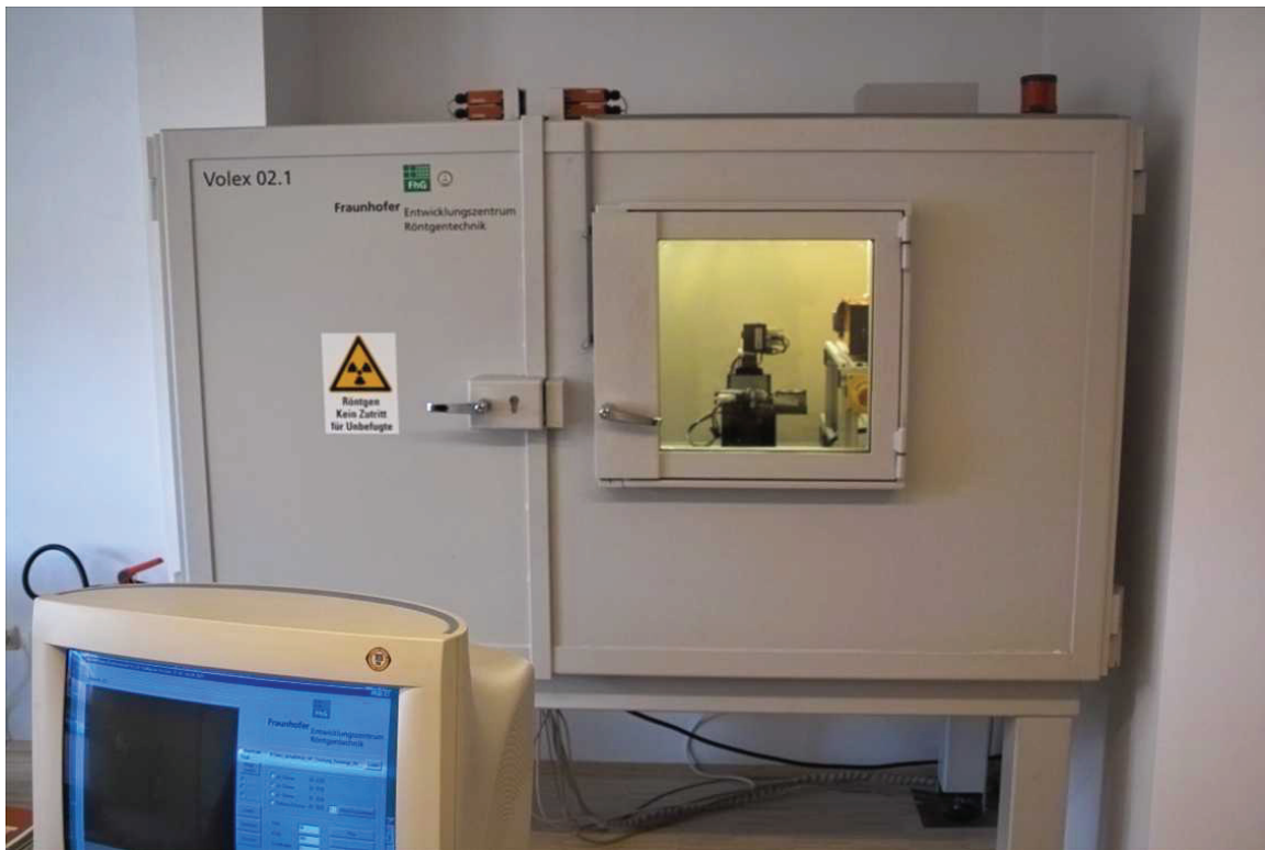
Bild 3.5: Ansicht auf die CT-Röntgenkabine im Betriebszustand
