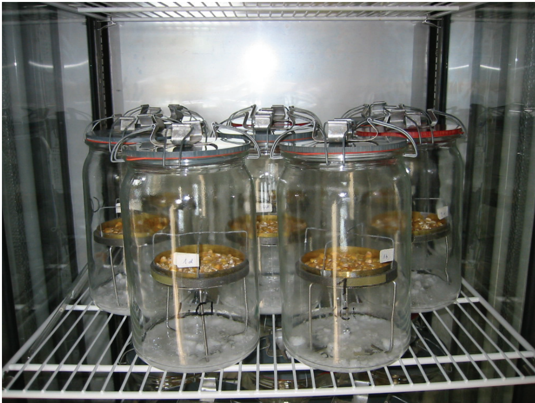
Bild 3.14: Körnermaisproben in Glasbehältern mit Salzlösung. Die Glasbehälter sind im Klimaschrank mit einer Innenraumtemperatur von 30 °C aufgestellt.
