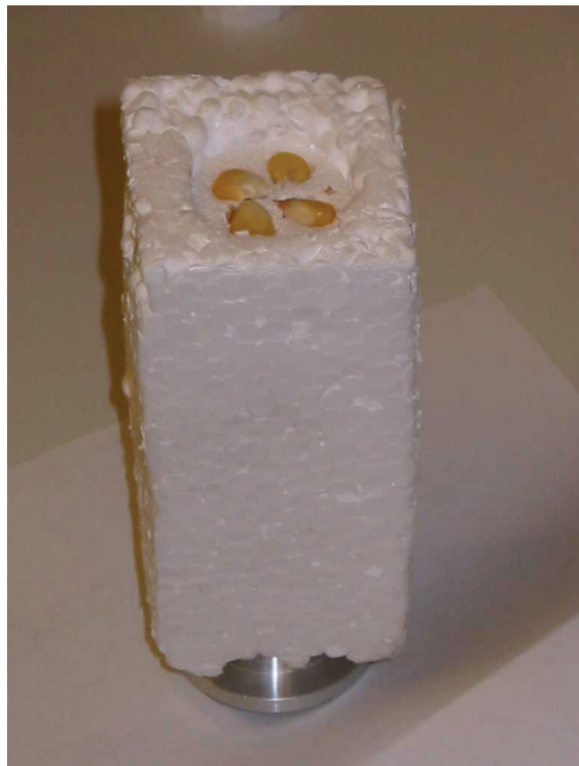
Bild 3.7: Einbettung der Maisproben in den Probeträger aus Styropor (jeweils vier Maiskörner in drei Ebenen)
