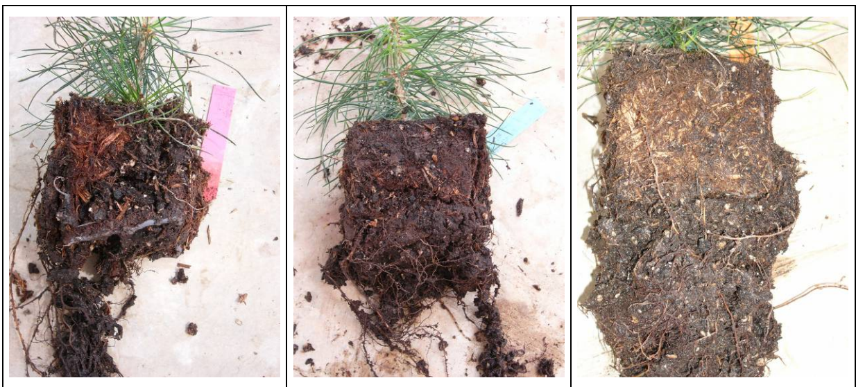
Abbildung 4.49: Pflanztöpfe (Wanddicke: 5 mm; Rohdichte: 400 kg/ m 3 ) aus rotfaulem Holzfasersubstrat gebunden mit Tannin (Links), Ligninsulfonat (Mitte) und Weizenprotein mit Mergal ® S 88 Paste (Rechts) nach 45 Wochen in einem Kultursubstrat. Die Versuchspflanzen (Kiefern Sämlinge) konnten sowohl den Boden, als auch die Seitenwände der Töpfe durchwurzeln.
