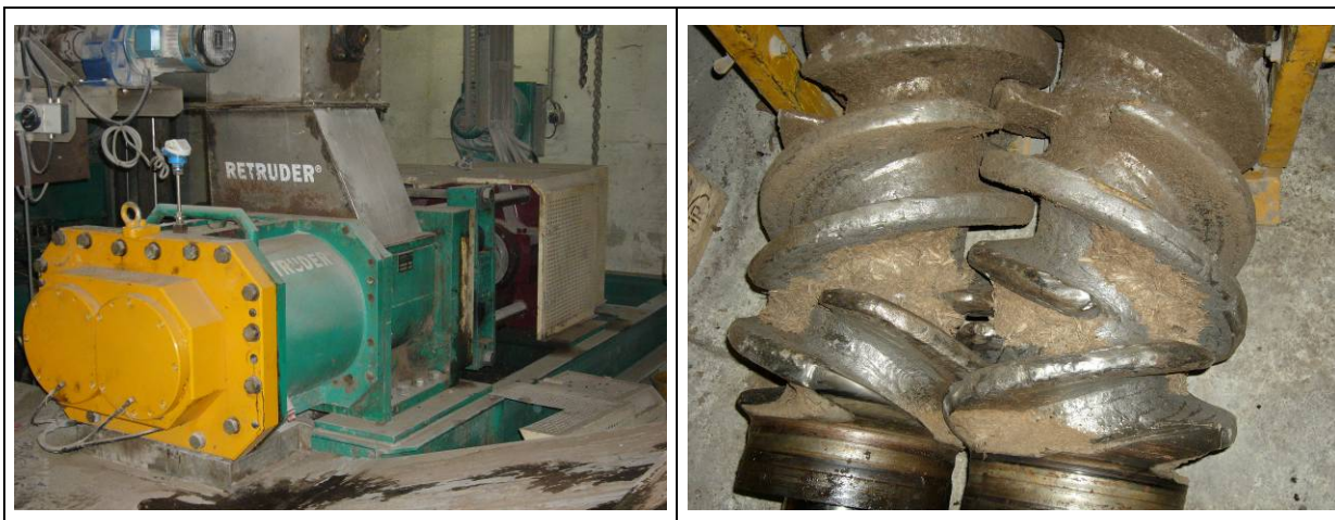
Abbildung 4.3: Der Aufschluss des Holzes zum Torfersatzstoff Toresa ® erfolgt im Extruderverfahren. Links: Extruder; Rechts: Schnecken im Extruder (Fotos: LUDWIG, 2004).
