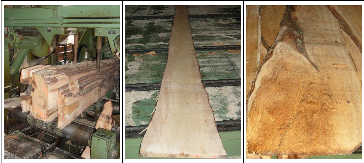
Abbildung 4.50: Links: Rotfauler Stammabschnitt im Vollgatter des Säge- und Hobelwerks Oberweser. Mitte: Brett aus noch beil- und nagelfestem Bereich. Rechts: Brett zur Herstellung der Hackschnitzel.
