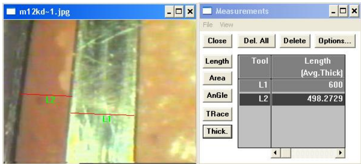
Abb. 11 a) Computerausdruck beim Messvorgang: Distanz zwischen Film und Referenzdraht vor Krafteinleitung; b) Computerausdruck beim Messvorgang: Distanz zwischen Film und Referenzdraht während der Krafteinleitung nach 2 Sekunden.
