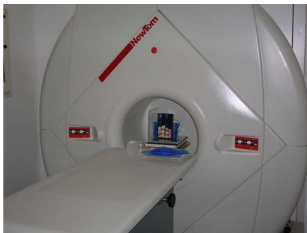
Abb. 17 Die Knochenproben im digitalen Volumetomographen Modell QR.DVT 9000 ®
