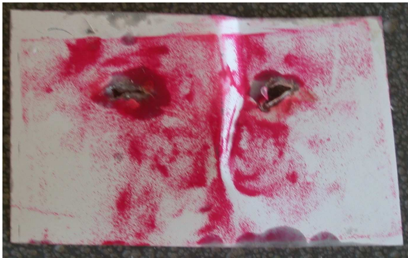
Abbildung -3-3 eingefärbte Druckmessfolie der LASA-DR-Schrauben ® -Rekonstruktion mit Hilfe der Fadenbrückentechnik
