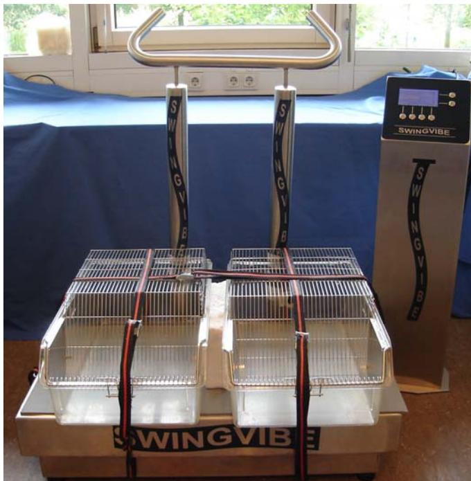
**Abb. II.3: Vibrationsgerät mit Bedienelement**
