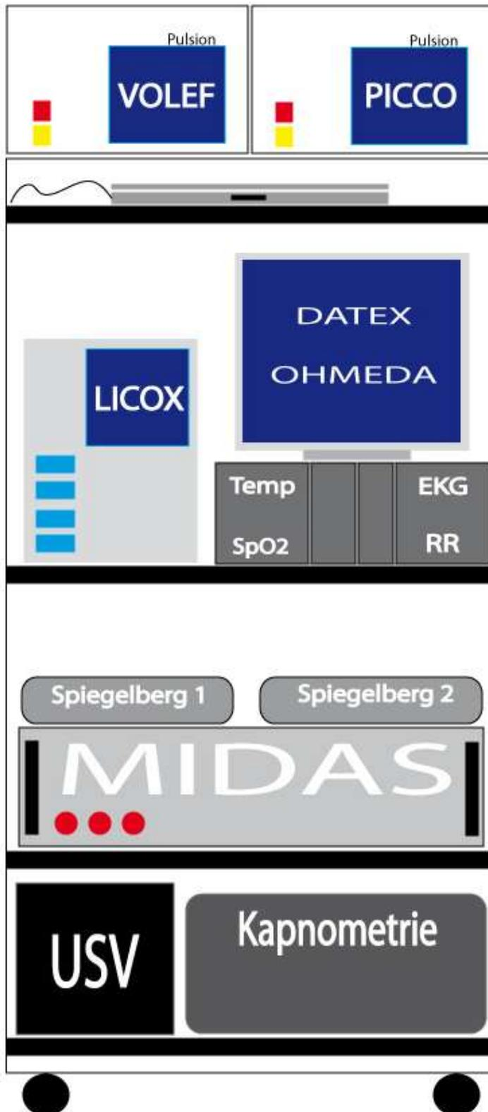
Die Abbildung zeigt den schematischen Aufbau der transportablen Messeinheit inklusive aller Messgeräte, Analog-Digital-Wandler, unterbrechungsfreier Stromversorgung und Laptop.
