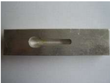
Abb. 3: Metallauflage mit Vertiefung zur Fixierung der Tibia
