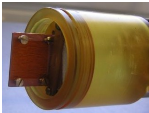
Abbildung 5.17. Modifizierung des Probenhalters zur Durchführung von Rauschmessungen mit parallel zur Schichtebene verlaufendem Magnetfeld.
