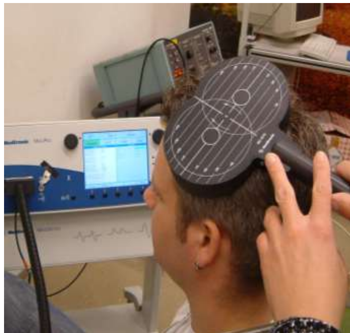
Abbildung 3 Fotodarstellung eines Probanden bei Versuchsdurchführung mittels Schmetterlingsspule (MagPro Stimulator)
