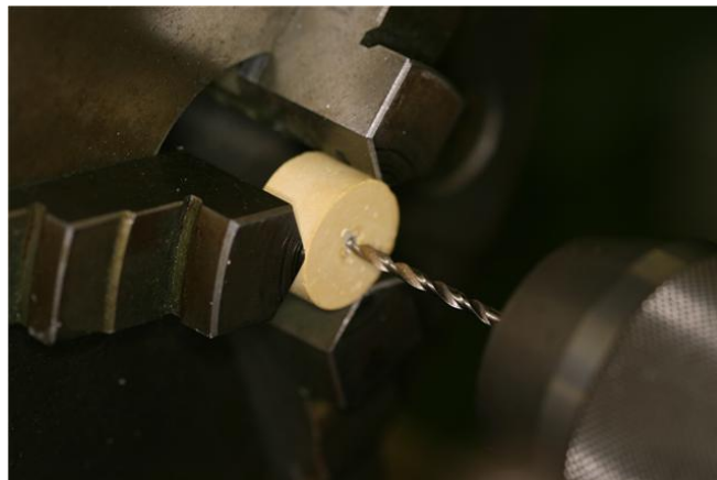
Abbildung 6: Anlegen der Normbohrung an der Unterseite des in Gips fixierten Messzahnes (ENGELKE 2010, S.12).
