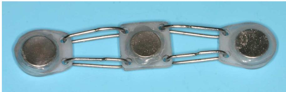
Abbildung 2:  $\text{Nd}_2\text{Fe}_{14}\text{B}$ -Magnetkette mit Kunststoffummantelung
