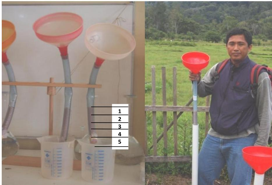
**Abb. 2.1: IER-Kollektor im Laborversuch und im Freilandeinsatz**
