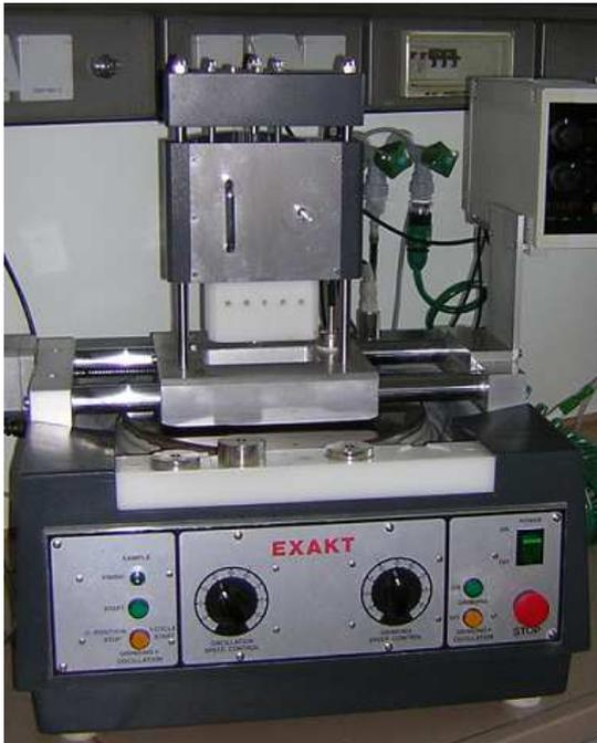
Abb. 3: Schleifmaschine der Firma Exakt
