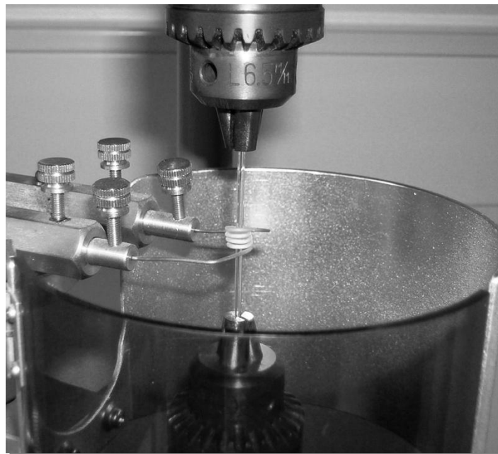
Abbildung 9: Kapillarschlingenziehgerät „Puller“ zur Herstellung von Glasmikroinjektionskanülen und Glasmikroelektroden. Eine dünne unter Zugspannung stehende Glaskapillare wird in der Mitte von einer Heizspirale erhitzt und die beiden Enden mit hoher Geschwindigkeit durch einen Elektromagneten auseinandergezogen. So entstehen zwei Glaskapillaren mit konisch zulaufenden Spitzen.
