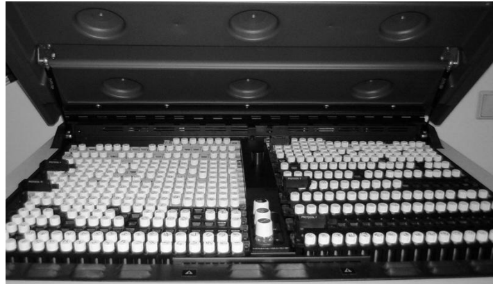
Abbildung 13: Flüssigkeits-Szintillations-Zähler bestückt mit Szintillationsgefäßen.
