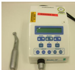
Abb. 6: Der Endo IT professional Motor mit Winkelstück
