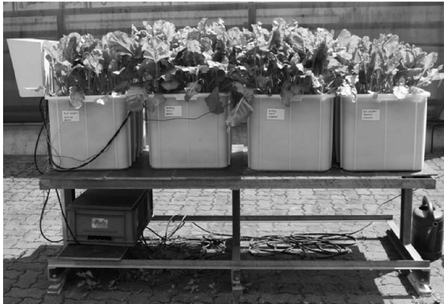
Abb. 7: Gefäßversuch mit anfälligen und resistenten Zuckerrüben-Genotypen zur Untersuchung der Resistenzstabilität bei unterschiedlichen Bodentemperaturen. Die linken zwei Gefäße werden über eine Bodenheizung beheizt, dabei entsteht eine Temperaturdifferenz zur unbeheizten Variante, die variabel eingestellt werden kann.
