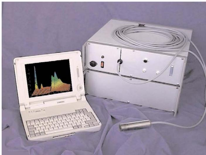
**Abbildung 3.1:** Ein Foto des CCD-Laserfluorimeters mit Steuerungscomputer. Der Laser nimmt das untere Gehäuse ein, die Nachweiseinheit mit der Elektronik befindet sich im oberen Gehäuse.
