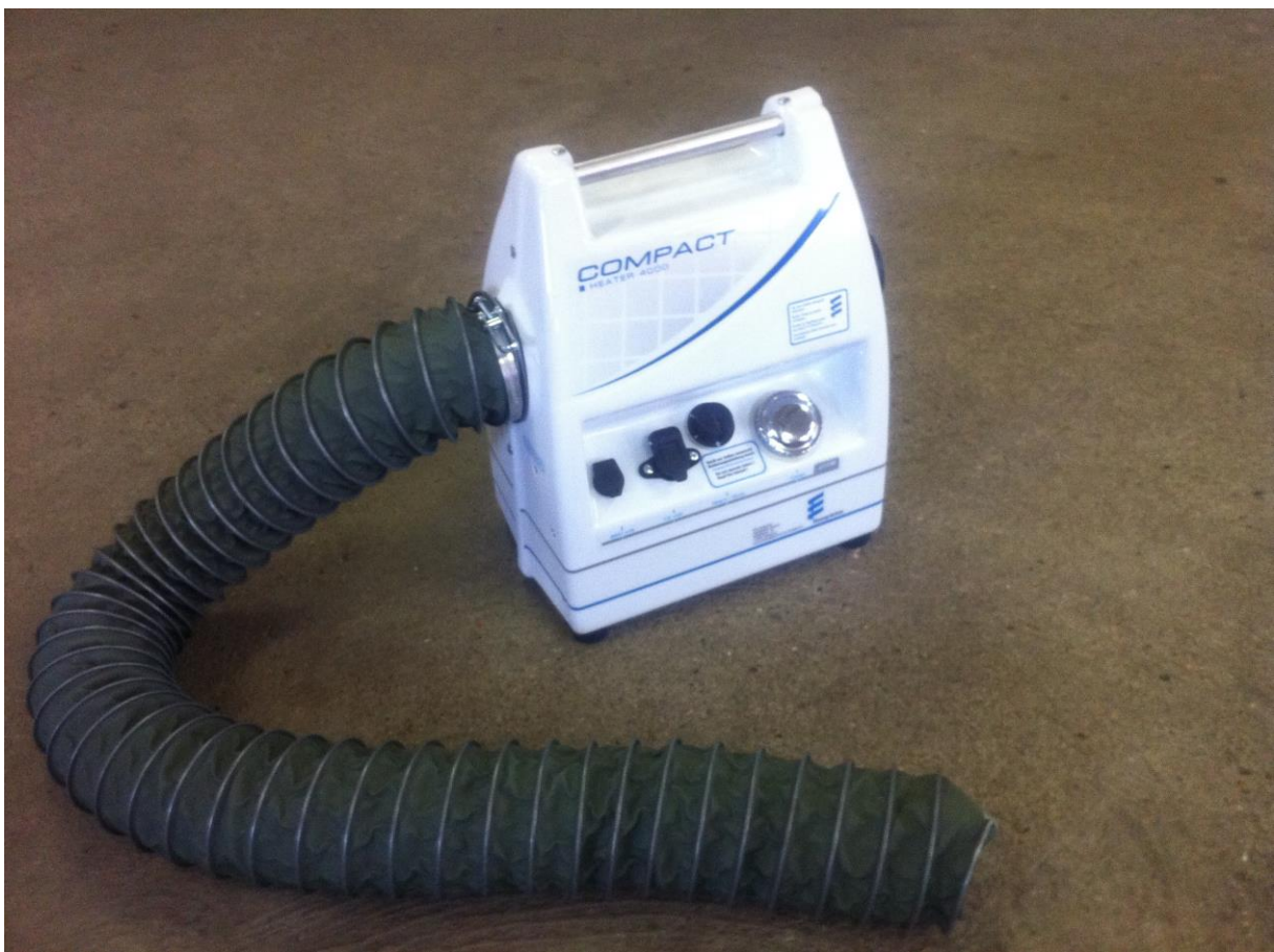
Abbildung 4: Konvektiver Luftwärmer Polarn 4000 der Firma Eberspächer. Quelle: Christopher Jebens
