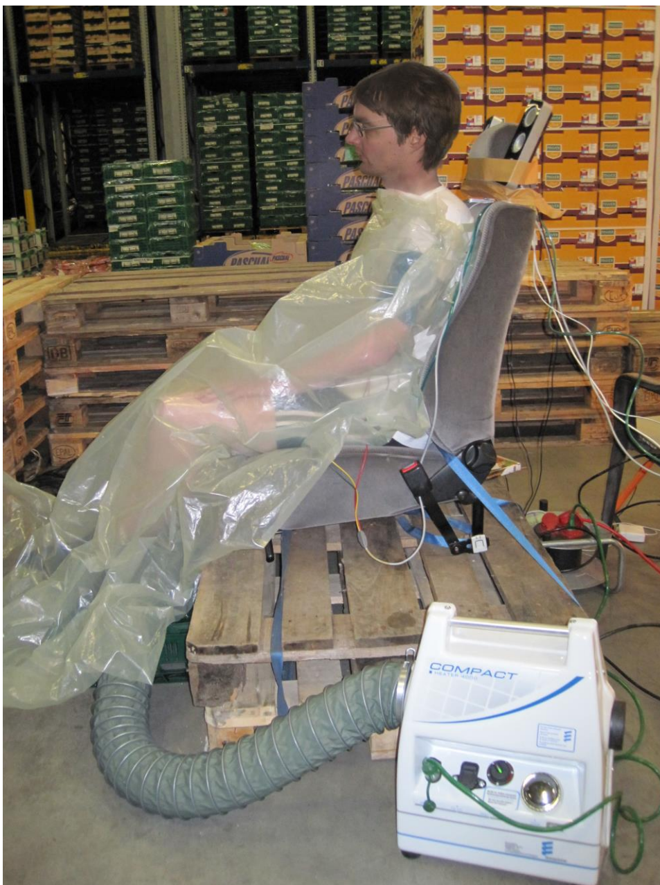
Abbildung 7 : Versuchsteil B: Wärmung mit Hilfe des konvektiven Luftwärmers. (Einwilligung zur Veröffentlichung des Fotos liegt vor).
