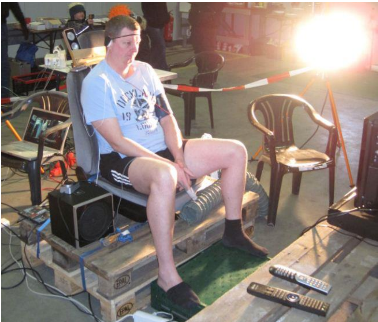
Abbildung 6: Versuchsteil A: Wärmung mit Hilfe des Halogenstrahlers. (Einwilligung zur Veröffentlichung des Fotos liegt vor).
