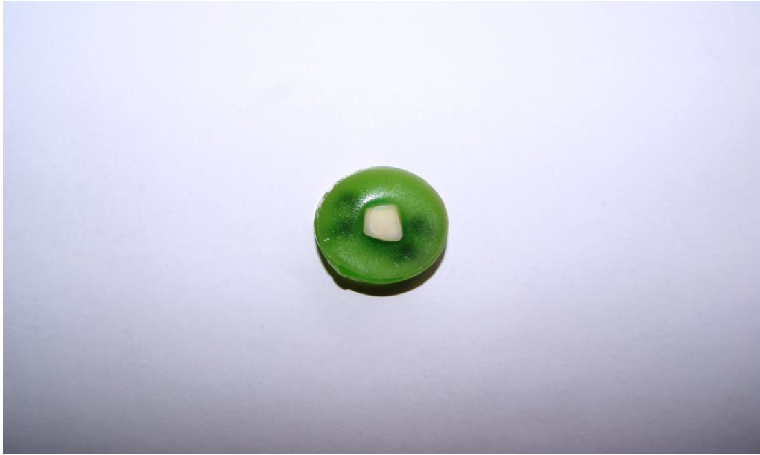
Abb. 7: In Kunststoff eingebettete Schmelzprobe
