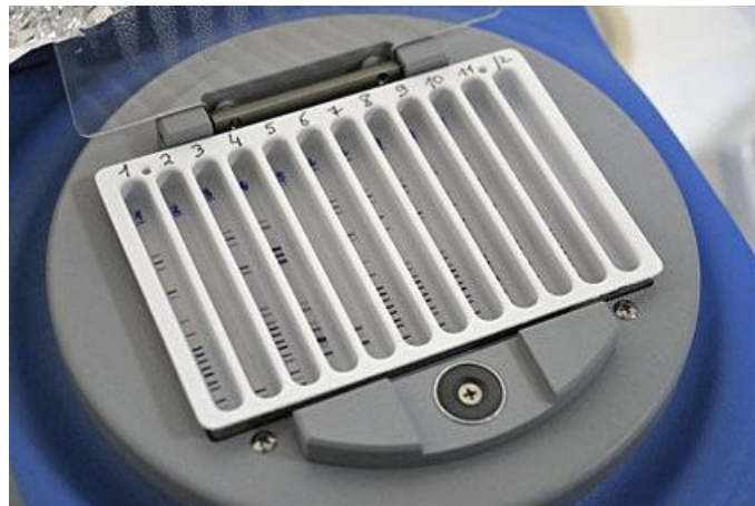
Abb.4: TwinCubator mit Wannenkavitäten und Membranstreifen der Firma Hain Lifescience (Nehren, Deutschland). (Die Verwendung von Abbildung 4 erfolgt mit freundlicher Genehmigung der Firma Hain Lifescience (Nehren, Deutschland)).
