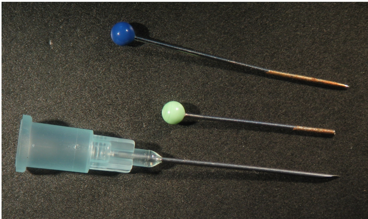
Abbildung 4.11: Visueller Vergleich dreier Nadeln. Oben und Mitte: Zwei gleichartige vernickelte Stecknadeln. Unten: Edelstahlkanüle (V2A).
