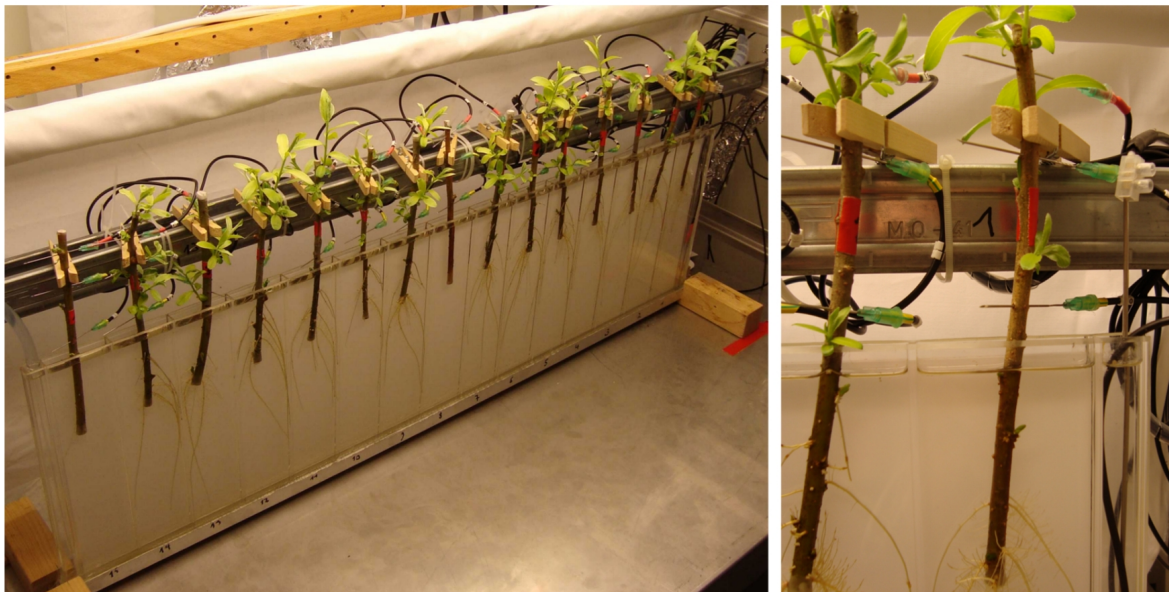
Abbildung 3.9: Fotos des Hauptversuchs 1 in der Klimakammer. Die Stecklinge wachsen in der Klimakammer in einer Plexigalküvette auf, die durch Stege in gleichgroße Kammern unterteilt wurde. Die Kontaktierung erfolgte, wie beschrieben, durch Edelstahlelektroden.
