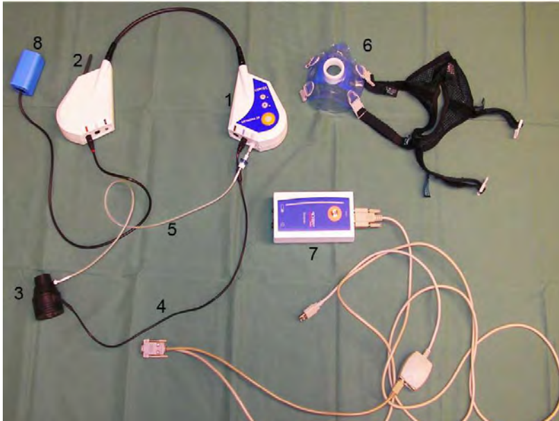
Abbildung 5: MetaMax ® 3B Basissystem (1) mit Telemetrie-Sender (2), Volumensensor (3), Volumen-Abfluss (4), Gas-Abfluss (5), Atemmaske (6), Telemetrie-Empfänger ohne Antenne (7) und Batterie (8) (Eich et al. 2009b).
