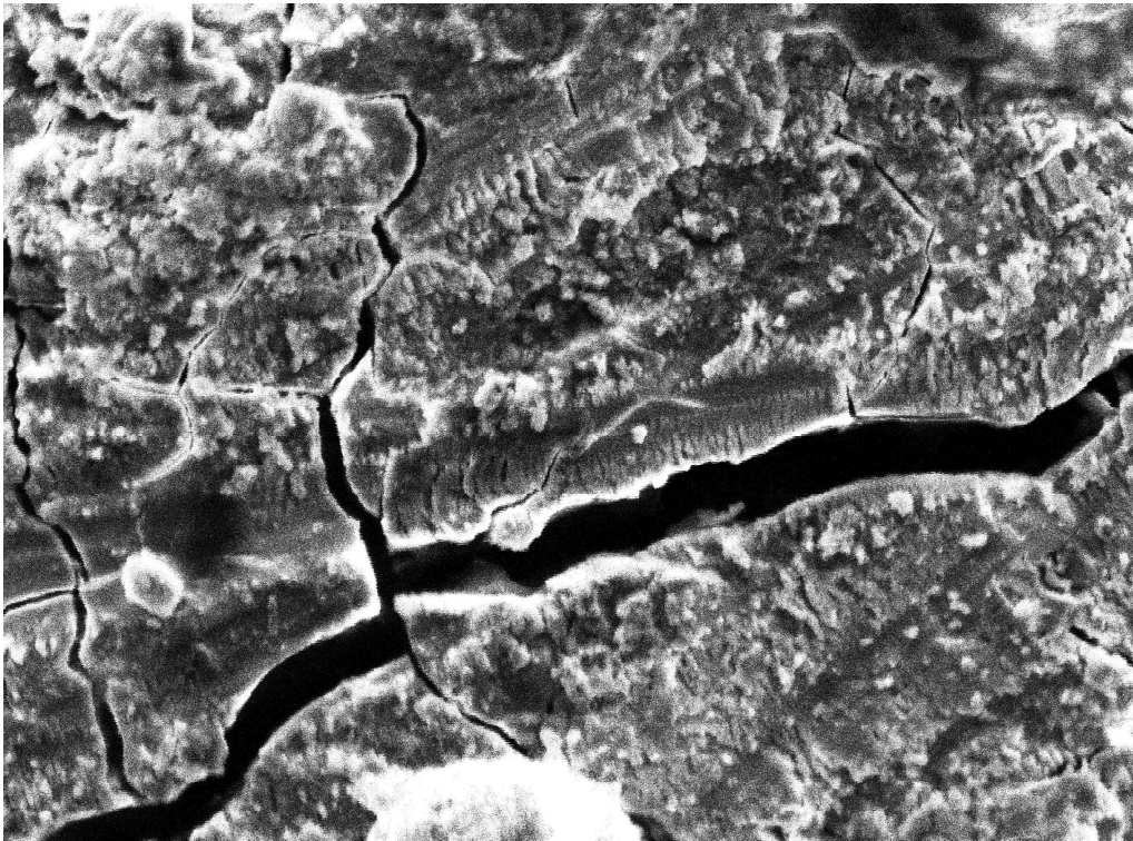
Abbildung 26: REM-Aufnahme (2589-fache Vergrößerung): Bakterienaggregation, eingebettet in einer Matrix aus extrazellulären Polysacchariden
