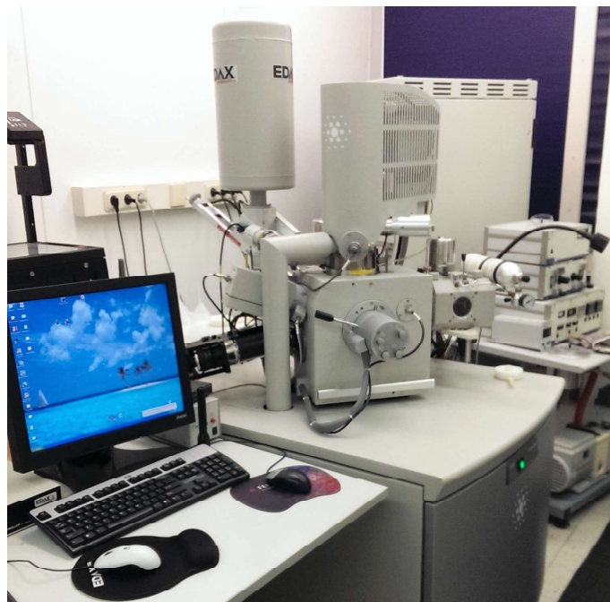
Abbildung 14: Rasterelektronenmikroskop (Quanta FEG 200, FEI Company, USA)
