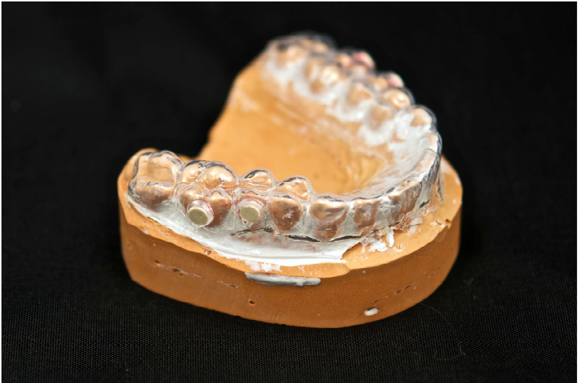
Abbildung 12: Fertiggestellte Schiene mit Probekörpern auf dem Modell
