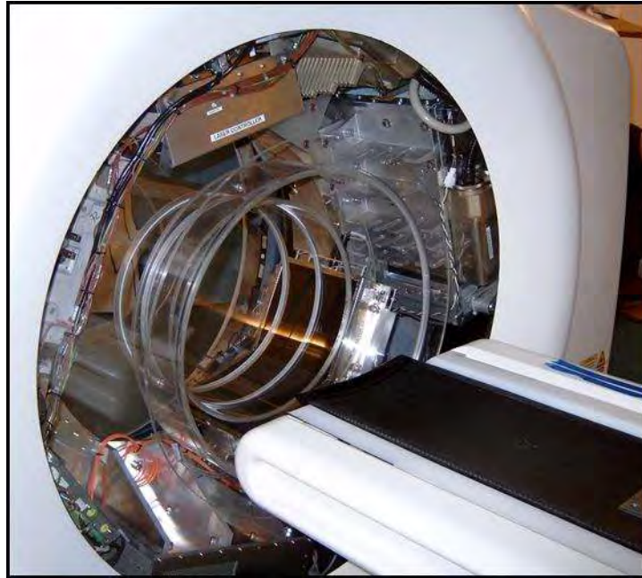
Abbildung 1: Prototyp eines fpVCT (GE Global Research, Niskayuna, NY, USA) in der Universitätsmedizin Göttingen. In der Bildmitte erkennt man die beiden Flächendetektoren (Quelle: eigene Abbildung)
