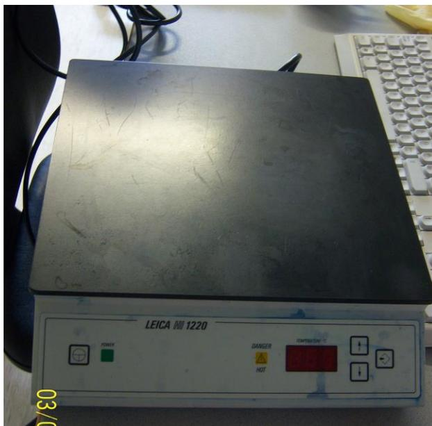
**Abbildung 10: Heizplatte für den Hotplate-Test**
