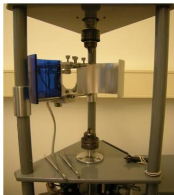
**Abbildung 9A-B: Darstellung des DMZ-Universal-Pullers**
