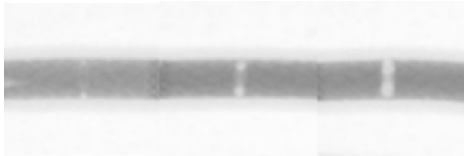
Abbildung 8: Die Stenosegrade im Pharosstent mittels DSA dargestellt, von links nach rechts 25 %, 50 %, 75 % im 4-mm-Modell
