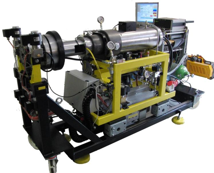
**Abbildung 4.15:** Rapid-Compression-Machine der Firma Testem [56].
