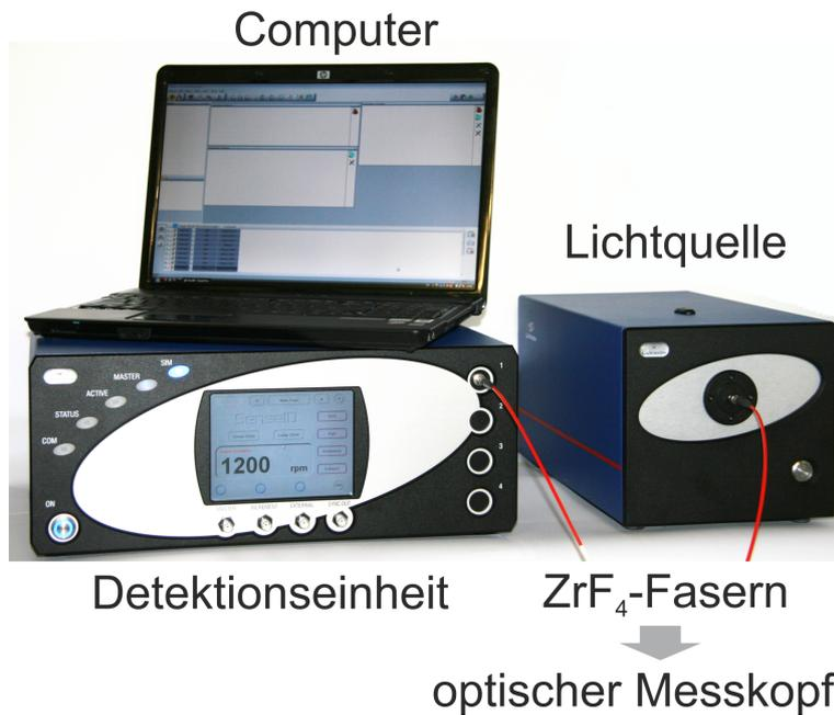
**Abbildung 4.1:** Die einzelnen Komponenten des ICOS-Systems ohne optischen Messkopf: Lichtquelle, Detektionseinheit, optische Fasern und Computer zur Datenaufnahme.
