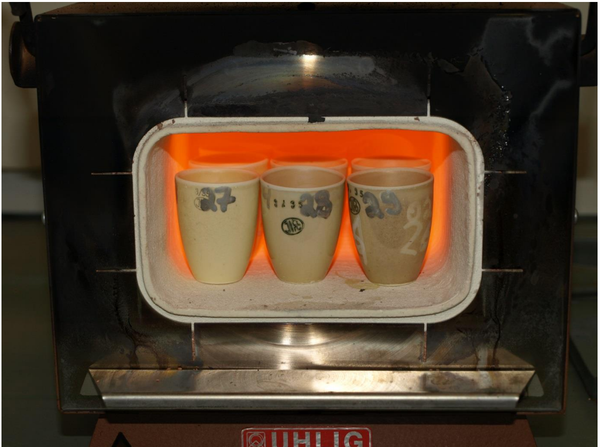
Abbildung 2: Muffelofen bei der Veraschung
