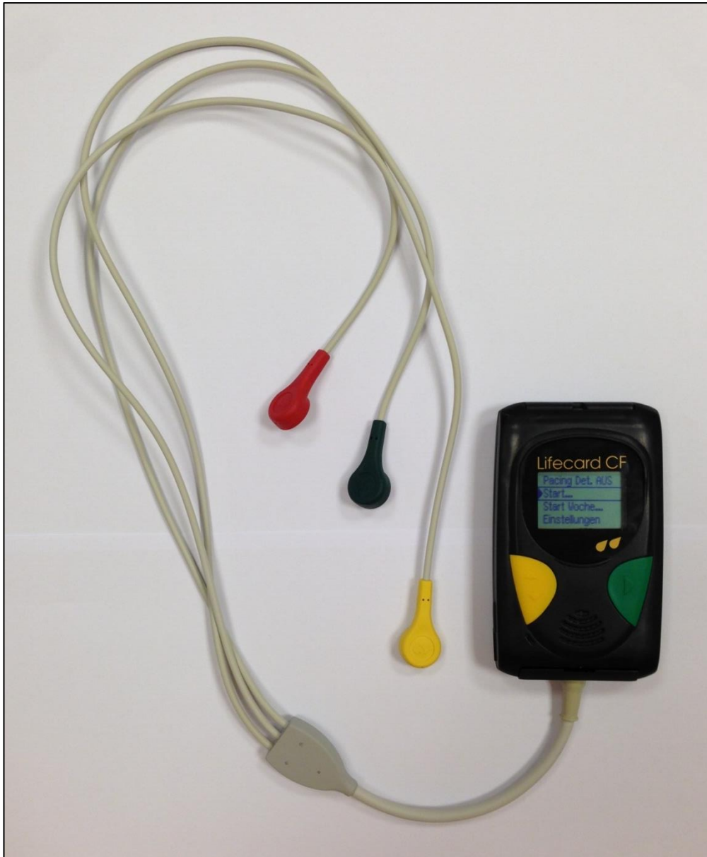
Abb. 16: Langzeit-EKG-Rekorder „Lifecard CF“, welcher im Rahmen der Studie eingesetzt wurde. Maße 96 x 57 x 18 mm, Gewicht 118g. Firma Del Mar Reynolds Medical Limited, Hertfort, United Kingdom. Quelle: eigenes Foto
