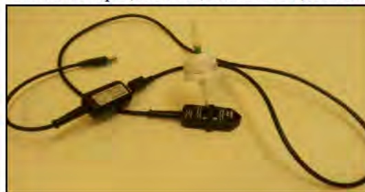
Abbildung 14: Messapparatur zur Manometrie (Aqua-Knot II Water Trap®, GDUSB, GMSD 2 BR, Heidelberger Verlängerung)
