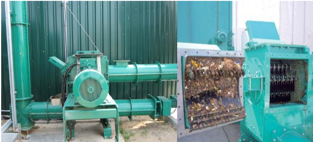
Abbildung 19: Abbildung der Hammermühle in der Gesamtansicht (links) und mit Einblick in den Innenraum (rechts) Quelle: Sawatzki (2011)
