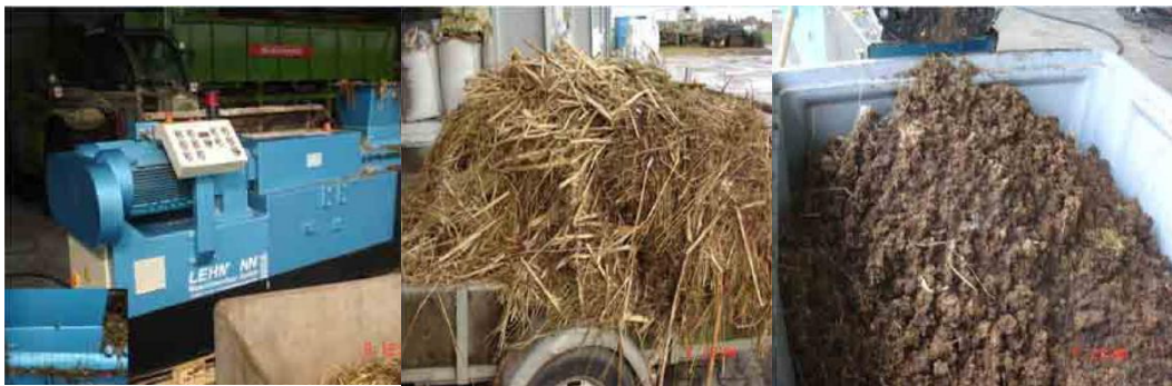
Abbildung 18: Abbildung des Lehman-Extruders in der Gesamtansicht (links) sowie von Landschaftspflege-Material unbehandelt (mitte) und nach Behandlung durch den Extruder (rechts) Quelle: Lehmann (2013)
