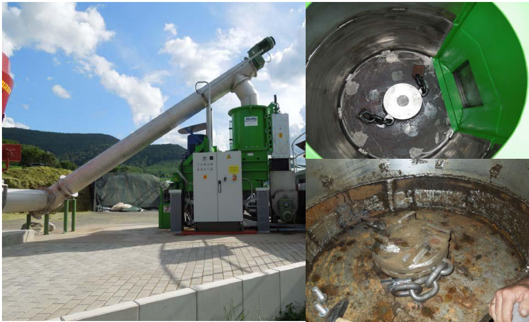
Abbildung 17: Querstromzerspaner MeWa, Gesamtansicht (links) und Einblick in den Innenraum (rechts oben und unten), Quelle: Mönch-Tegeeder (2013)
