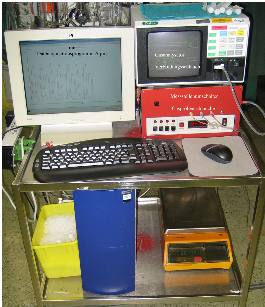
Abbildung 8: Datenerhebung der Sevoflurankonzentration. Die farbig markierten Gasprobenschläuche leiteten das Gasgemisch von den jeweiligen Messpunkten zu dem Messstellenumschalter und damit zum Gasanalysator. Gelb markierter Gasprobenschlauch = Gasgemisch des endotrachealen Tubus, rot markierter Gasprobenschlauch = Gasgemisch des Gasauslass des Oxygenators, blau markierter Gasprobenschlauch = Gasgemisch des venösen Kardiotomiereservoirs.
