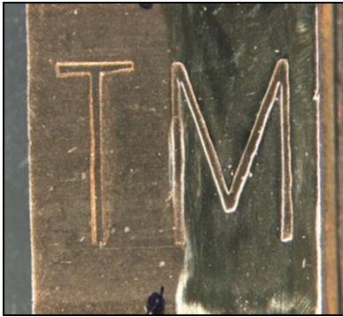
Abb.24: Phantommetallplättchen Unbehandelte/polierte Seite, vor Bestrahlung
