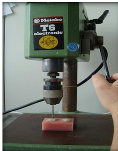
Abbildung 12 Betätigung des Hebels und standardisierter Bohrvorgang
