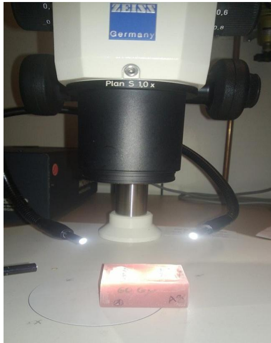
Abbildung 22: Auflichtmikroskop Zeiss Stemi SV11 mit Probe
