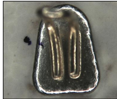
Abb.25a: Nickel-Titan-Schleife auf Zement befestigt mit Markierung, nach Bestrahlung
