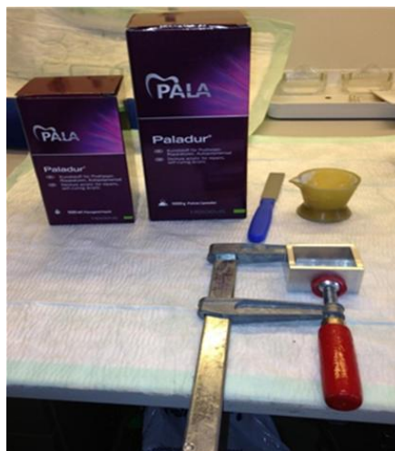
Abbildung 8: Kunststoff Paladur®, Anrührbecher, Gießform und Schraubzwinde
