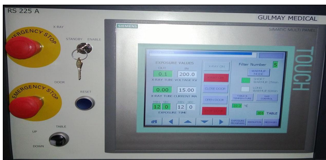
Abbildung 16: Bildschirm der experimentellen Röntgenstrahlanlage mit Bestrahlungszeit, Röhrenspannung, Stromstärke, Filter und Tischhöhe
