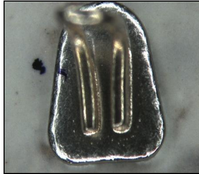
Abbildung 4: Vorversuche- Gruppe3: Nickel-Titan-Schlaufen mit Harvard-Zement auf Phantommetallplättchen befestigt. Bild vor der Bestrahlung
