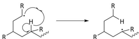
Schema 2-2: Entstehung eines tertiären *midchain*-Radikals durch intramolekularen 1,5-Wasserstofftransfer (*backbiting*).
