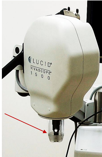
Abb. 16: Schwenkbarer Kopf des Vivascope® 1500 mit dem Gewebekegel (roter Pfeil) und dem Lasertubus (weißer Stern).
