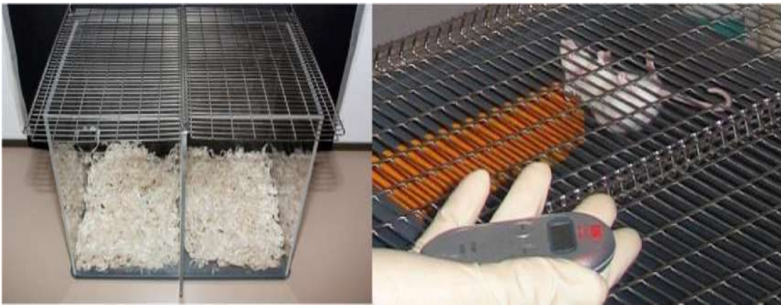
Abbildung 2: Gitterhängetestvorrichtung ( Hanging wire ) (Quelle: eigenes Bildmaterial)
